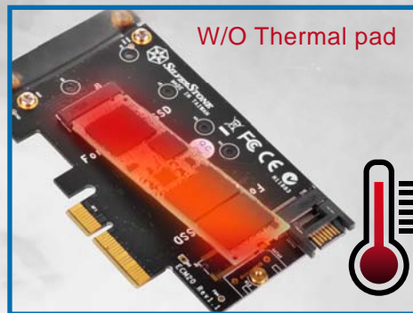
Prima (nessun pad termico): 86 gradi Celsius (186,8 gradi Fahrenheit)
