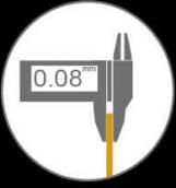
Cable de cobre ultra-fino de 0,08mm
